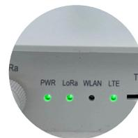
Si le câble ethernet est alimenté les 3 LEDs à l'arrière s'allument
