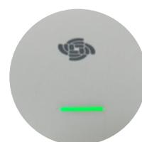
Si la LED s'allume en vert elle est connectée au réseau. Si la LED s'allume en rouge, merci de contacter le service client.
