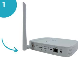
Vissez l'antenne à l'arrière de la gateway
