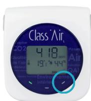
Faites le reset de votre capteur en appuyant 2 secondes sur le bouton de droite
