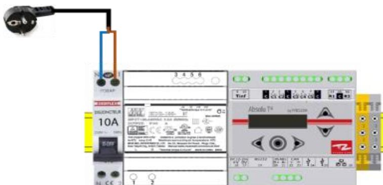
Les câbles utilisés sur l'arrivée Ethernet et le Bus de communication des modules doivent obligatoirement être de catégorie 5 minimum et avoir une jauge compris entre – ou égale à – AWG 22 et AWG 24.
