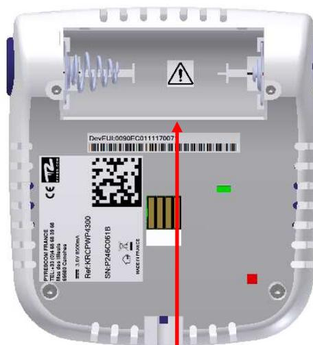
Remplacer la pile et attendre 1 minute le démarrage de l'écran
